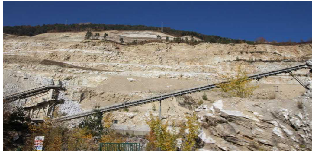
VUE 2 - Zone d'exploitation, ses transporteurs à bandes et ses fronts de taille
