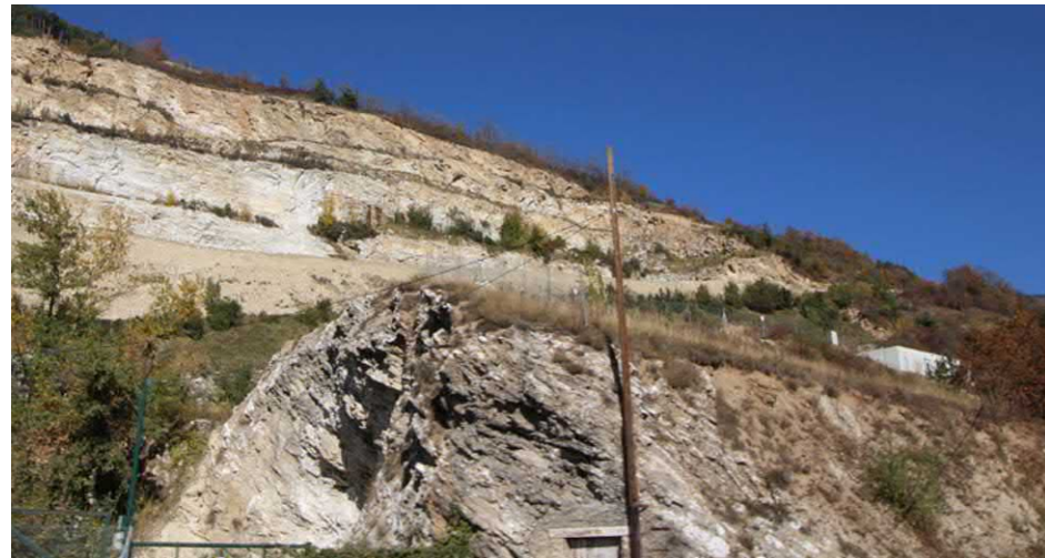
VUE 4 - Front de taille de la carrière actuelle et bandes en lanières replantées
